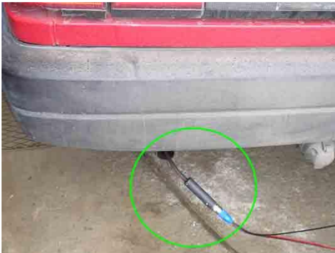
Подключение датчика разрежения к выхлопной трубе.
